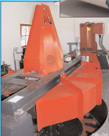
Doppelt regulierte Kaplanmaschine von GHE
