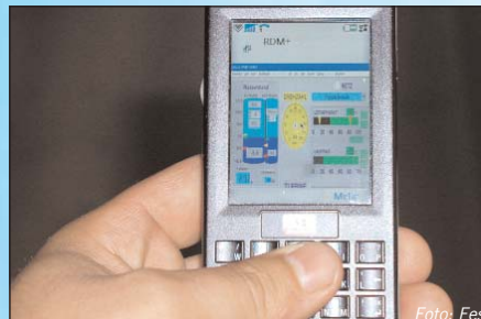
Per Mauszeiger u. Tastatur kann Markus Fesl die Anlage - von jedem beliebigen Standort aus - voll funktionsfähig steuern. Visualisierung und Eingabefunktion wurden auf das Handy übertragen.
