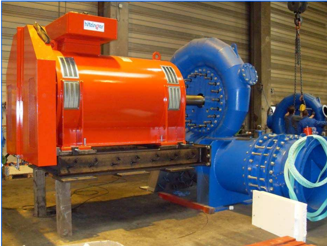
Zusammenbau bei HYDRO ENERGY Assembling at HYDRO ENERGY
