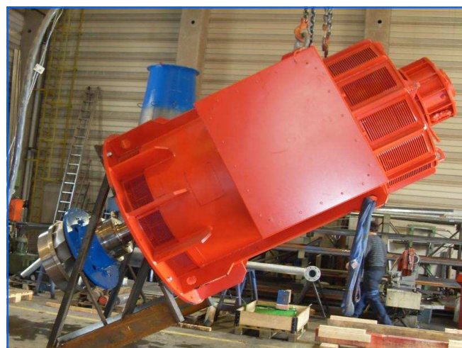
Zusammenbau Generator und Laufrad Assembling of the generator and the runner
