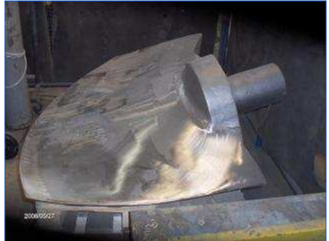
Kaplanflügel vor Drehbearbeitung Kaplan blade before turning work
