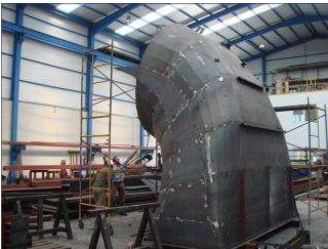
Saugrohrkrümmer Draft tube bend
