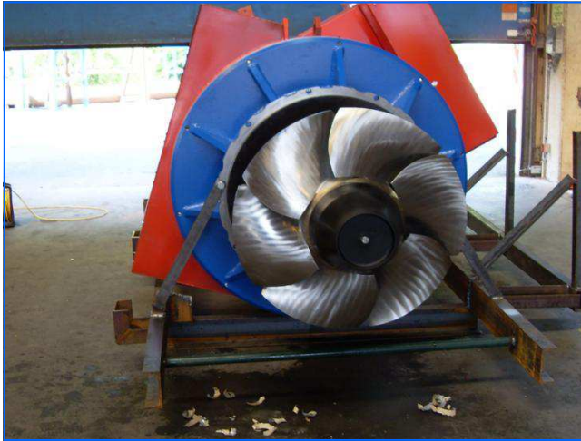
Generator mit Laufrad Generator with runner
