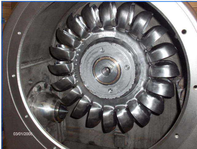
Vormontage der Turbine bei Global Hydro Energy sub-assembly of turbine at Global Hydro Energy
